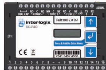
Il comunicatore mette a disposizione ingressi/uscite, un simulatore di linea, per catturare il contactID e trasformarlo in notifiche push ed e-mail, e una porta seriale per la telegestione delle centrali testate. Il tutto tramite il cloud UltraSync™, sicuro e affidabile, e l'APP UltraSync+.
