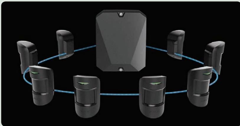
Fibra supporta connessioni con topologia ad anello. Con Hub Hybrid nel sistema ci possono essere fino a 4 anelli
